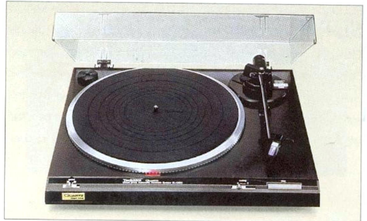
SL-Q 200 Halbautomatischer Plattenspieler mit quarzgeregeltem Direktantrieb. Komplette Frontbedienung. TNRC-Zarge. Magnettonabnehmer EPC-P 30. Gleichlaufschwankungen \pm 0,035 %. Rumpel-Geräuschspannungsabstand: - 78 dB. Gehäusefarben: schwarz und silber.
