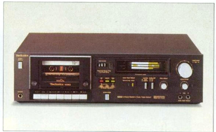
RS-M 263 3-Kopf-HiFi-Cassettendeck mit Hinterbandkontrolle, Dolby-B. Automatische Bandsortenwahl (Normal/CrO 2 /Reineisen). Regelbare Vormagnetisierung. FL-Meter mit „peak-hold“. Übertragungsbereich 25 Hz – 19 kHz (Reineisen). Gehäusefarben: schwarz und silber.
