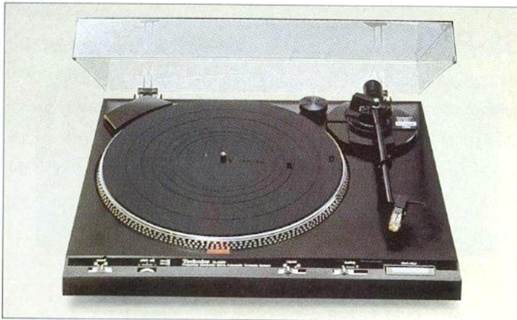
SL-B 300 Vollautomatischer Plattenspieler mit Riemenantrieb. Automatische Plattendurchmesserabastung. Komplette Frontbedienung. Wiederholautomatik. TNRC-Zarge. Magnettonabnehmer EPC-P 27. Gleichlaufschwankungen \pm 0,06 %. Gehäusefarben: schwarz und silber.
