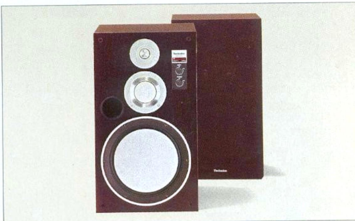
SB-X 700 3-Weg-Lautsprecherbox mit Wabenscheiben-Flachmembran. Baßreflex-System. Pegelregler für Hochtöner und Mitteltöner. Impedanz 8 Ohm. Überlastungsanzeige mit Schutzrelais. Belastbarkeit: 90 W Sinus/180 W Musik. Gehäusefarbe: rosenholz.
