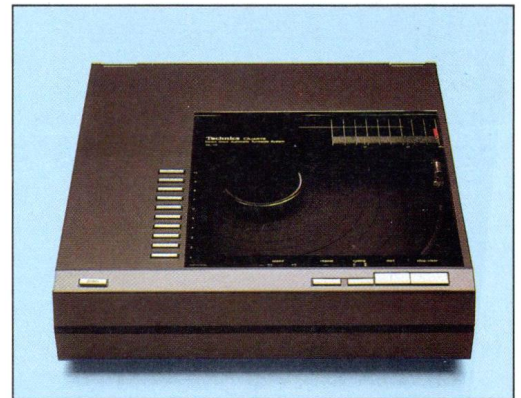
⑫ SL-15 Vollautomatischer Plattenspieler mit quartzgeregeltem Direktantrieb und servogeregeltem Tangentialtonarm.
