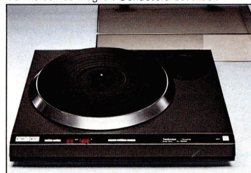
SL-151 MK 2 Quarzgeregeltes, direktantriebenes Laufwerk ohne Tonarm. LED-Anzeige für Geschwindigkeit und Feinregulierung. Geschwindigkeitsfeinregulierung in 0,1\% -Schritten bis max. \pm 9,9\% . Gleichlaufschwankungen \pm 0,035\% . Gehäusefarbe: schwarz.
