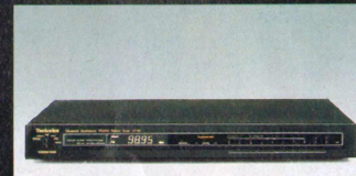
ST-S7 UKW/MW-Stereo-Quarz-Synthesizer-Tuner. „Slim-Line“. Übertragungsbereich 5–18.000 Hz (± 1,5 dB). UKW-Eingangsempfindlichkeit 0,85 µV (75 Ohm). Programmierbarer Timer, digitale Frequenzanzeige. Gehäusefarbe: Schwarz + Silber.
