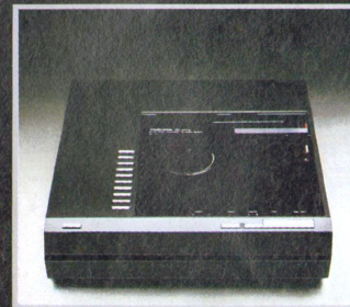
SL-15 Vollautomatischer Plattenspieler mit quartzeregelmtem Direktantrieb; servoregelmter Tangentialtonarm mit Magnettonabnehmer EPC-202. Musik-Selektor zum Vorwählen von bis zu 10 Musikstücken. Gleichlaufschwankungen 0,035%. Horizontal- und Vertikalbetrieb möglich. Gehäusefarbe: Schwarz.
