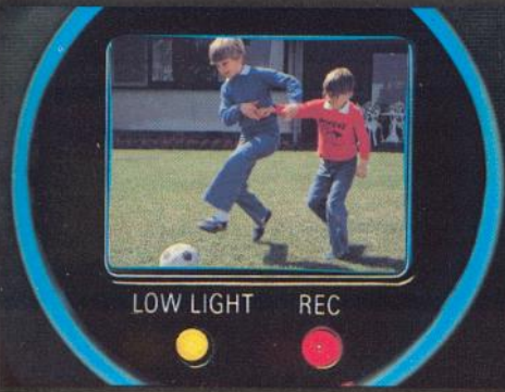
Bei der Blendeneinstellung hilft eine Leuchtdiode. Der s/w-Monitor ist Kontrollleinheit für die Aufzeichnung, den Bildausschnitt sowie Helligkeits-, Entfernungs- und Zoomeinstellung.
