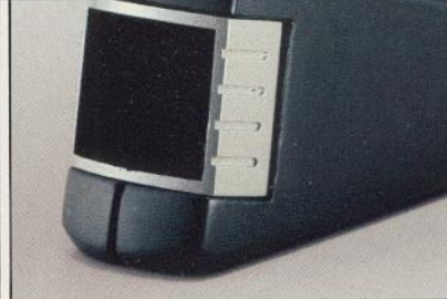
Das Elektret-Kondensator-Mikrofon ist in den Kameragriff eingebaut.
