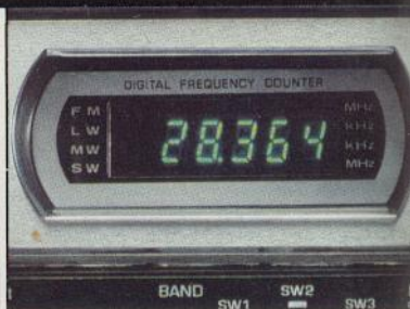
Digitalanzeige mit einer Anzeigegenauigkeit von ± 10 kHz im FM-Bereich und ± 1 kHz im AM-Bereich.
