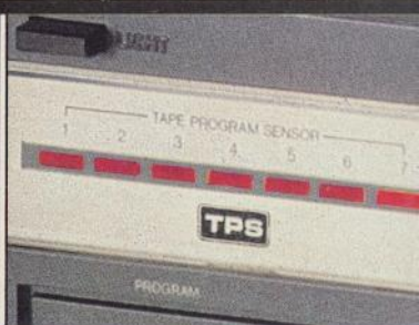
Bandschlaufautomatik (TPS) zum Auffinden bestimmter Bandstellen
