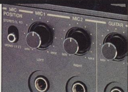
Ein eingebauter Gitarrenverstärker und die Zuschaltung von zwei Mikrofonen mit Mischmöglichkeiten bieten vielfältige Einsatzmöglichkeiten
