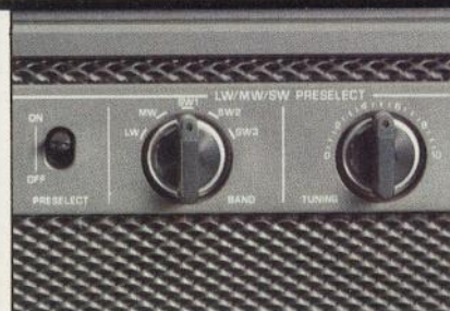
Preselector - zur Vorwahl im KW/LW/MW-Bereich - für verbesserte Eingangsempfindlichkeit und Spiegelfrequenz-Unterdrückung.
