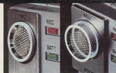
Eingebautes Kondensatormikrofon mit veränderlicher Richtcharakteristik
