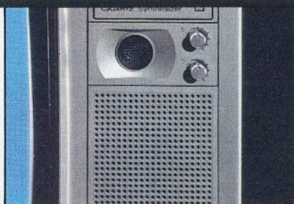
Zweiweg-Lautsprechersystem mit getrenntem Hoch- und Tieftöner.
