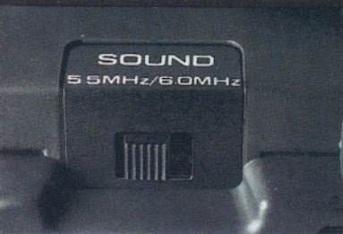
Umschaltbarer Tonträger von 5,5 MHz (deutsche Fernsehnorm) auf 6 MHz (englische Fernsehnorm).
