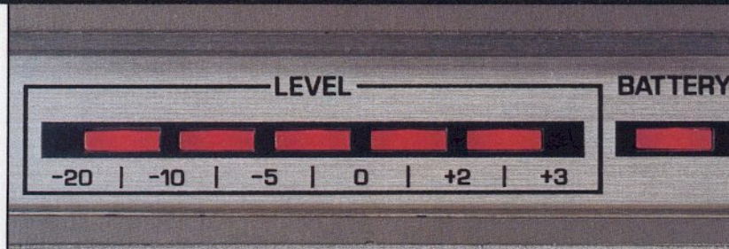
LED-Anzeige für Batteriezustand; 5-teilige LED für Aufnahmeaussteuerung.
