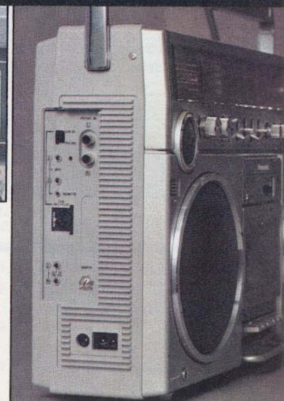
Vielfältige Anschlußmöglichkeiten für 2 Mikrofone, 2 Lautsprecher, MM-Plattenspieler, Kopfhörer, 12 V-Auto/Boots-Batterie, DIN-Eingang.
