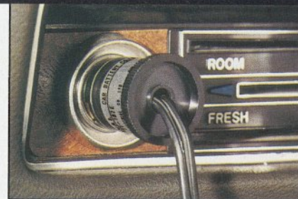
Auto-/Bootsakku-Anschluß über Zigarettanzünder am Armaturenbrett.
