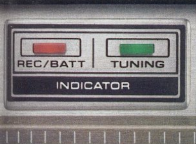
2 LEDs zur Kontrolle von Aufnahme/Batteriezustand und Abstimmung
