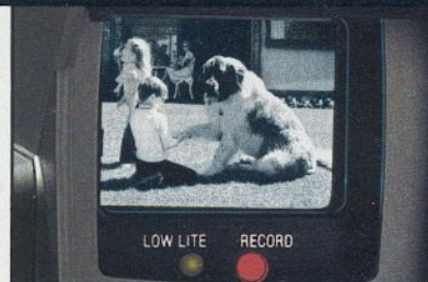
Bei der Blendeneinstellung hilft eine Leuchtdiode. Der s/w-Monitor ist Kontrollleinheit für die Aufzeichnung, den Bildausschnitt sowie Helligkeits-, Entfernungs- und Zoomeinstellung.
