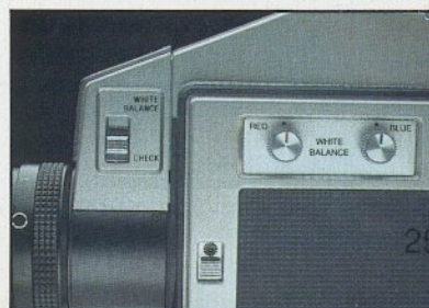
Die Kontrollleinheit für Farbtemperaturregelung und Weißabgleich ist in die Kamera integriert.
