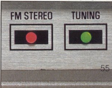
„Ambience“ – elektronische Stereo-Basisverbreiterung für verbesserten Raumklang. Korrekte Senderabstimmung und UKW-Stereo-Empfang werden mit 2 LED's angezeigt.
