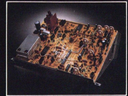
Platinenmodul des 99-Kanal-Quarz-Synthesizertuners
