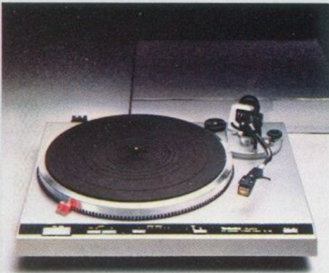
SL-Q 3 Vollautomatischer Plattenspieler mit quartzeregelmtem Direktantrieb. Gleichlaufschwankungen 0,035%. Inkl. Magnettonabnehmer EPC-207 C. Gehäusefarbe: Schwarz + Silber.
