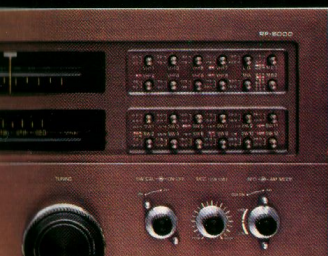
Wellenbereiche, davon allein 12 KW-Bänder. Mit Knopfdruck dreht sich das gewünschte Band in das Fenster der Skala.
