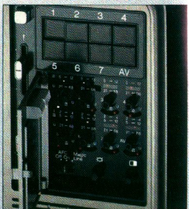
7 Programmwahl-tasten und AV-Kanalwähler. Die Bedienelemente für die Grundein- stellung liegen geschützt hinter einer Blende.
