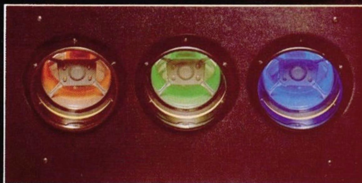
Drei Farböhren projizieren über einen Spiegel auf den 152 cm-Bildschirm (Diagonale). Erst hier entsteht das helle, brillante Farbbild.
