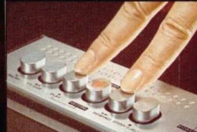
Mithörmöglichkeit beim schnellen Vorlauf und zum schnellen Auffinden unbespielter Bandstellen.
