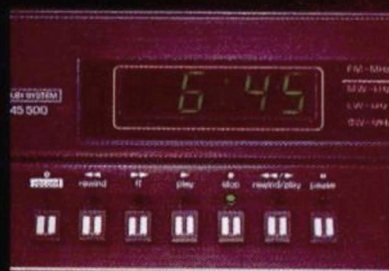
Mit der Zeitschaltuhr lassen sich alle wichtigen Funktionen vorprogrammieren. Sensorbedienung für Cassetten-Recorder.
