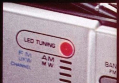
Ist der Sender scharf eingestellt, leuchtet die LED-Anzeige auf.
