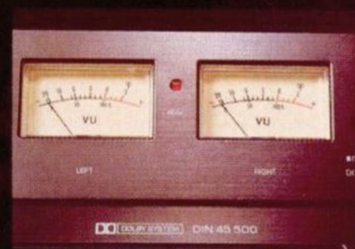
2 VU-Meter zur Aufnahme-Aussteuerungskontrolle. Die LED-Lampe zeigt an, wenn der 0-dB-Pegel erreicht ist und schützt vor Übersteuerung.
