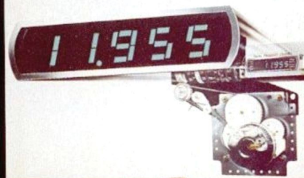
Digital-Frequenzanzeige und Allzahnradantrieb sorgen für genaue, schlupffreie Sendereinstellung.
