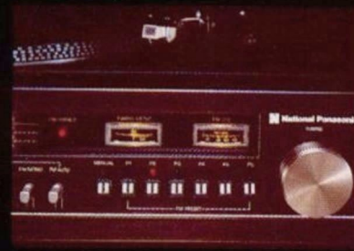
Auf 6 UKW-Sensor-Stationstasten lassen sich Sender speichern, die jederzeit abrufbereit sind. Bei der exakten Grundeinstellung hilft das Tuning-Meter und die extra UKW-Skala.
