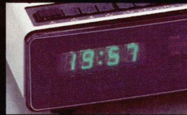
Stufenlos einstellbare Helligkeit der Leuchtziffernanzeige.
