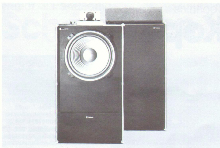
SB-6000 Zweiwegboxen mit linearem Phasengang. Unverfärbtes, reines Klangbild und Wiedergabetreue. 30 cm Tieftöner aus Aramid-Faser. Verzerrungsarmer Hochtöner. Die akustischen Zentren sind durch räumliche Versetzung der Lautsprecher, bei gleichzeitiger, enger Placierung in der Vertikalen so angeordnet, daß der lineare Phasengang erreicht wird.
