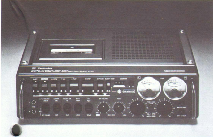
RS-646DS Tragbares Stereo-Cassetten-Tonbandgerät. Gleichlaufschwankungen nur 0,1%, Frequenzgang von 40 bis 14.000 Hz DIN (CrO 2 -Band). Elektronisch geregelter Gleichstrom-Servomotor, Mikrofonverstärker mit rauschermem IC, Dolby-Rauschunterdrückung, Bandendanzeige und synchronisierte Eingangspegelregler. Mit großem Monitor-Lautsprecher (Durchmesser 100 mm) ausgerüstet.
