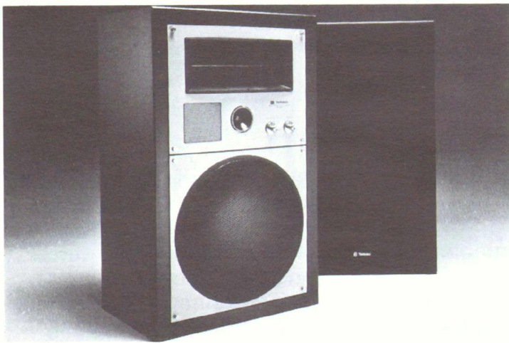
SB-660 Dreiweg-Baßreflexbox. Belastbarkeit 70 W, 30 cm Tieftöner im Baßreflexgehäuse, Multizellular-Hornlautsprecher (25 x 10 cm) für den mittleren Bereich und 5 cm Hornlautsprecher für den Hochtonbereich. Getrennte Pegelregler. Ausgerichteter Konusrand und langhubige Schwingspule für hohen Wirkungsgrad und große Zuverlässigkeit.
