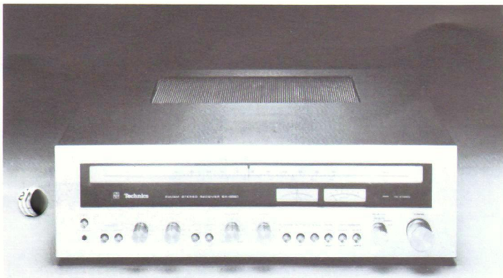
SA-5560 UKW-/MW-Stereo-Receiver. Stabilisiertes Netzteil und Ausgangsleistung von 108 W Sinus pro Kanal. Klirrfaktor nur 0,1%. Massiver Netztransformator und zwei Elektrolyt-Kondensatoren mit einer Kapazität von je 15.000 µF. Rauscharme Phono-Entzerrerschaltung mit linearem Fremdspannungsabstand. Eine PLL-Schaltung in IC-Bauweise sorgt bei UKW-Stereoempfang für saubere Kanaltrennung und ausgezeichnete Stabilität. Anschlußmöglichkeit für zwei Bandgeräte.
