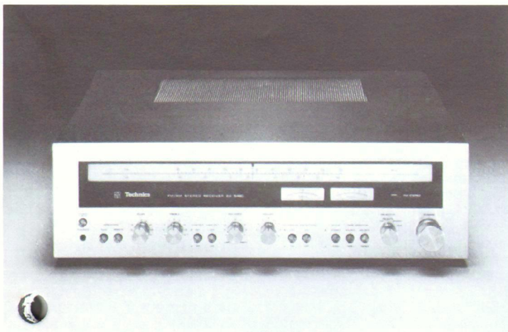
SA-5460 UKW-/MW-Stereo-Receiver. Ausgangsleistung 78 W Sinus pro Kanal. Klirrfaktor 0,1%. Rauscharme Phono-Entzerrerschaltung für ausgezeichneten Fremdspannungsabstand. Hohe Empfindlichkeit und Selektivität der UKW-Stufe. Aufwendige Schaltungstechnik. Anschlüsse für zwei Tonbandgeräte.
