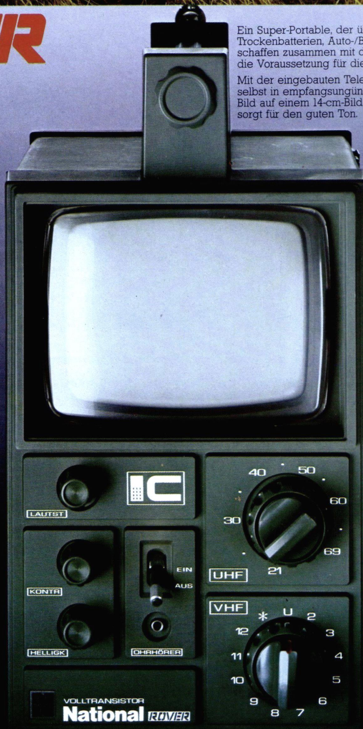
3fach Stromversorgung durch Monozellen, 220 V Netzbetrieb oder Auto-/Bootsakku.
