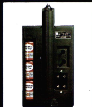
3fach Stromversorgung durch Monozellen, 220 V Netzbetrieb oder Auto-/Bootsakku.
