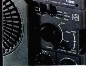
AFC- und DX-Schaltungen sorgen für klaren Empfang. Die regelbare Empfindlichkeit – eine Seltenheit bei Geräten dieser Preisklasse – ist die Voraussetzung zum Peilen.
