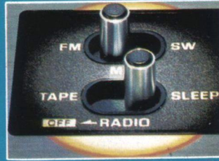
„Schlafmatic“ schaltet Radio oder Recorder nach 30, 45 oder 60 Minuten selbsttätig ab
