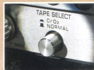
Bandwahlschalter für CrO 2 /Normal-Cassetten.
