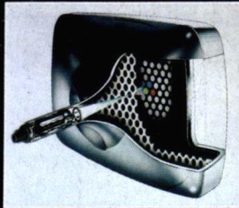
Die Quintrix-Lochmaske – für mehr Helligkeit, mehr Kontrast, mehr Scharfe.
