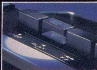
Auto-Stop Automatische Geräteabschaltung am Bandende
