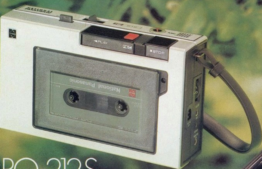
Auto-Stop Automatische Geräteabschaltung am Bandende
