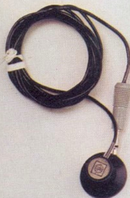
RP-963 Telefon-Adapter für alle Cassetten-Recorder (vom FTZ nicht zugelassen).
