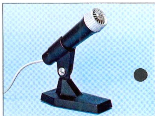
Tandberg TM4 ist ein dynamisches Mikrofon - speziell für Modell 12 hergestellt. Es wird mit einem verstellbaren Stativ geliefert. TM4 hat Kugelcharakteristik, das bedeutet, das Mikrofon hat gleiche Empfindlichkeit für Schall aus allen Richtungen. Tandberg TM4 ist ein Mikrofon, das sich besonders für hochwertige Aufnahmen sowohl für Sprache als auch Musik eignet. Frequenzgang - 60 bis 17.000 Hertz \pm 3 dB Empfindlichkeit 0,092 mV/Microbar - bei 1000 Hertz Impedanz 200 Ohm
