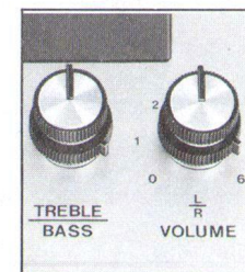
Utgångsnivån regleras med två volymkontroller, en för varje kanal. Det finns också kontinuerligt variabla bas- och diskantkontroller.
