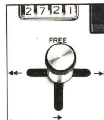
En-spak betjening av hurtig frem- og tilbakespoling og normal fremdrift for opptak og avspilling.
