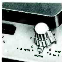
Un botón de doble control para la intensidad de reproducción en ambos canales. Selector de sonido sobre sonido con 3 posiciones: Prueba-AB, normal y sonido sobre sonido.
