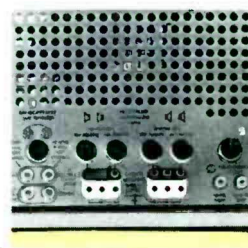
La Huldra tiene todas las posibilidades de conexión deseables. — Va provista de pre-amplificador incorporado para captador magnético.
