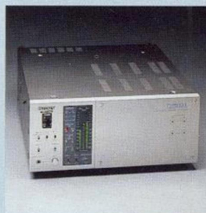
Der Sony PCM-Prozessor PCM-1630 spielt eine entscheidende Rolle beim Zusammenmischen der einzelnen Tracks für die beiden digitalen Kanäle.
