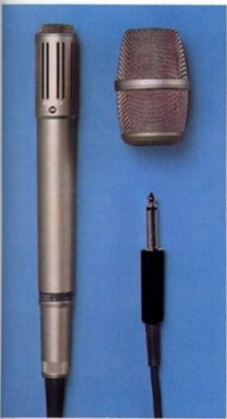
ECM-270 F Ausgezeichnetes Elektret-Kondensator-Mikrofon mit Nierencharakteristik. Frequenzgang von 40 bis 16.000 Hz. Stromversorgung über 1,5 V-Mignon-Zelle.
