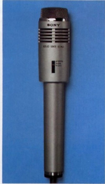
ECM-B 11 A Vielseitiges Elektret-Kondensator-Mikrofon mit Nierencharakteristik. Naturgetreue Echo-Einrichtung im gesamten Frequenzbereich von 60 bis 13.000 Hz. Funktionswahl über dreistufigen Schalter mit den Positionen Ein/Aus/Echo. Anschluß: 6,3 mm Klinkenstecker.
