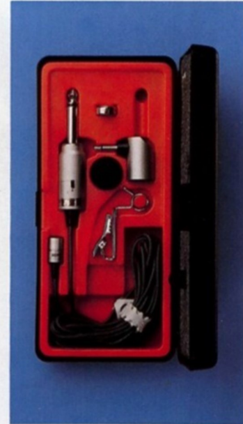
ECM-150 Mit einem Durchmesser von nur 8,5 mm und einer Länge von nur 15 mm eines der kleinsten Elektret-Kondensator-Mikrofone der Welt. Lavalier-Mikrofon mit Kugelcharakteristik. Zubehör: Windschutz, Übergangstecker für 3,5 und 6,3 mm-Klinkenbuchse. Übertragungsbereich: 40 bis 13.000 Hz.
