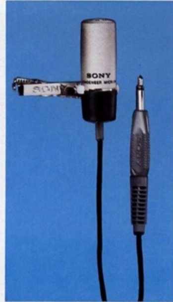
ECM-16 Elektret-Kondensator-Mikrofon mit Kugelcharakteristik. Durch minimale Abmessungen und Ansteck-Clip sehr bequem zu handhaben. Anschluß mit 3,5 mm Klinkenstecker (passend zu Sony Diktiergeräten). Übertragungsbereich: 50 bis 13.000 Hz.
