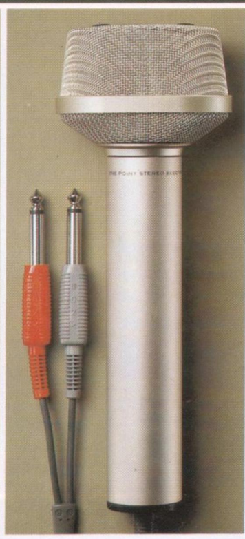
ECM-99 A Electret-Kondensator-Mikrofon. One-point-Stereo-Ausführung mit 2 Kapseln. Eingebauter Windschutz. Frequenzgang: 50–12.000 Hz. Anschluß: 2 x 6,3 mm Klinkenstecker. Ausgangsimpedanz: 250 Ohm.
