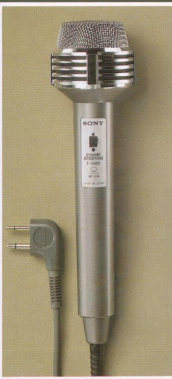
Frequenzgang: 80–12.000 Hz. Anschluß: F-500 mit 3,5 mm Klinkenstecker. F-500 S mit Kombistecker 3,5 und 2,5 mm Klinke.
