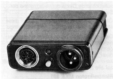
Batterieadapter MZA 10-U (Art.-Nr. 1546) Zum Anschluß des „Micromike” an symme- trische niederohmige N-Eingänge. Der Ausgangspegel entspricht dem dynamischer Mikrofone. 3poliger Cannon-Anschlußstecker.
