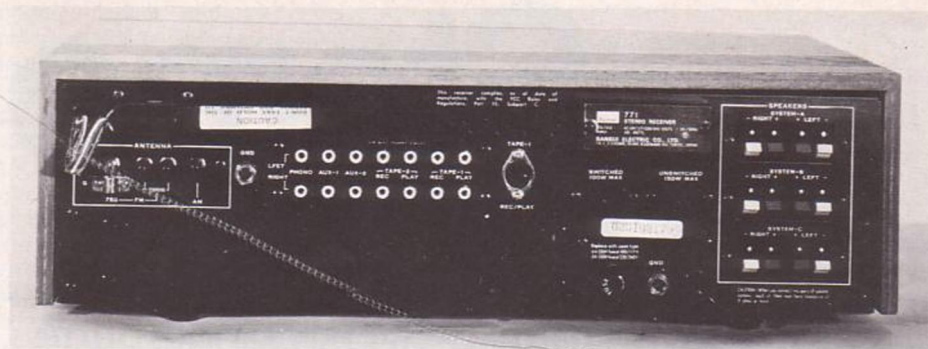
1 Rückseite des Sansui 771 Empfänger-Verstärkers
