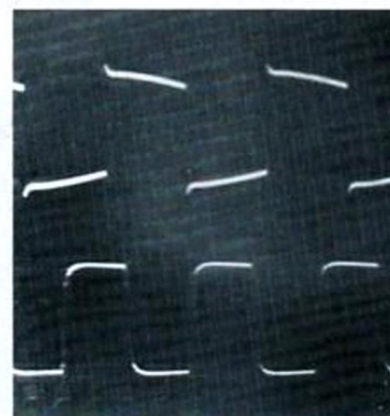
10 Oszillogramm der Rechteckübertragung, gemessen über Eingang Aux bei -6 dB unter Vollaussteuerung für die Impulsfolgenfrequenzen 100 Hz (oben) und 5 kHz (unten)
