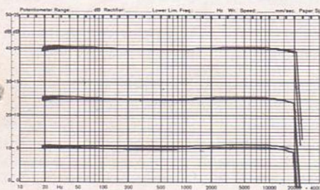
4 Frequenzgang bei Mittenstellung des Tiefen- und Höhenreglers sowie Pegeln zwischen -6 dB, -21 dB und -36 dB unter Vollaussteuerung
