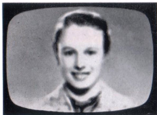
Abb. 5 Bild unscharf Automatic-Vorwahl (18) nachstellen
