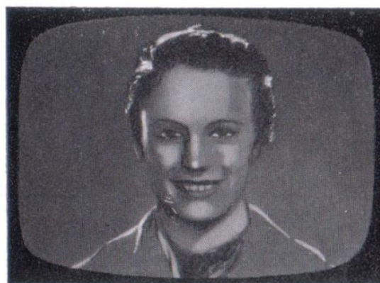
Abb. 4 Helligkeit zu klein Regler (19) aufdrehen
