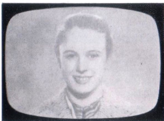
Abb. 3 Helligkeit zu groß Regler (19) zurückdrehen
