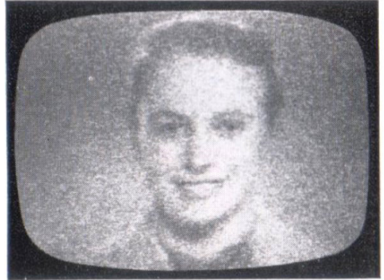
Abb. 8 Zu schwach einfallender Sender, Antenne verbessern!
