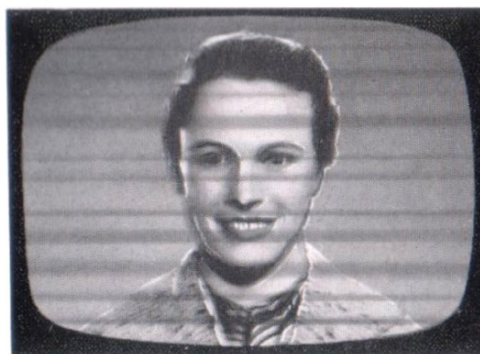
Abb. 6 Bild verzerrt, Automatic-Vorwahl (18) nachstellen
