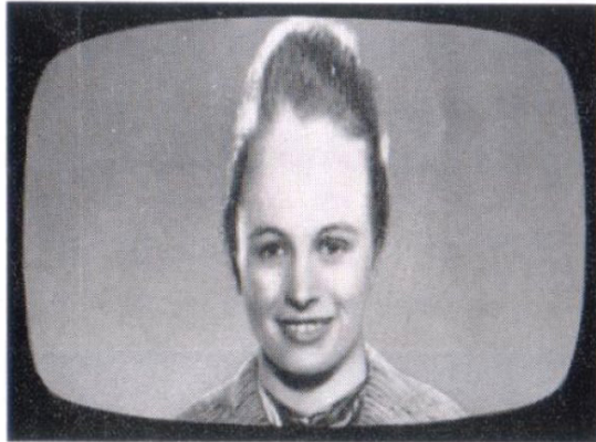
Abb. 11 und Abb. 12 Regler „Vert. Linearität“ und „Bildhöhe“ falsch eingestellt
