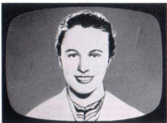
Abb. 1 Kontrast zu groß Regler (30) zurückdrehen
