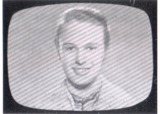
Abb. 10 Störstrahlung durch Rundfunkgerät oder Amateur-Sender (Streifen können auch andere Lage haben)
