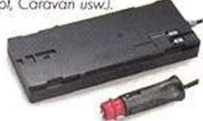
SABA Bordnetz-Adapter BNA 73 Adapter zur Stromversorgung des Video-Recorders CVR 6073 portable mit Camera oder des Video-Monitors CVM 73 aus einem 12-Volt-Bordnetz. Wird wie der Akku an das Gerät angeschlossen. Anschluß bei Autos über den Zigaretten-Anzünder. Wechselstecker für andere 12-Volt-Anschlüsse (Boot, Caravan usw.).
