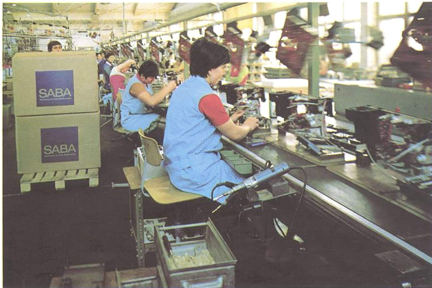
Verschalten von fertigmontierten Leiterplatten von der Bauteilseite her zu kompletten Chassis.
