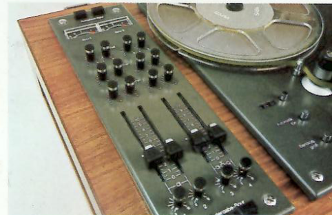
Das Regiepult: Als Besonderheit besitzt das SABA TG 600 SH ein Vierkanal-Mischpult mit Flachbahnreglern. Viele spezielle Stereo-Trick-Effekte sind möglich. Zusätzlich (unter anderem) acht Klangregler: eine Neuheit in der Heimstudio-Technik.
