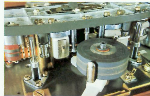
Der Kopfträger: Das SABA TG 600 SH hat einen Halbspur-Ferrit-Löschkopf, einen Halbspur-Stereo-Aufnahme- und einen Halbspur-Stereo-Wiedergabekopf sowie einen Viertelspur-Stereo-Wiedergabekopf. Der Kopfträger ist leicht austauschbar.
