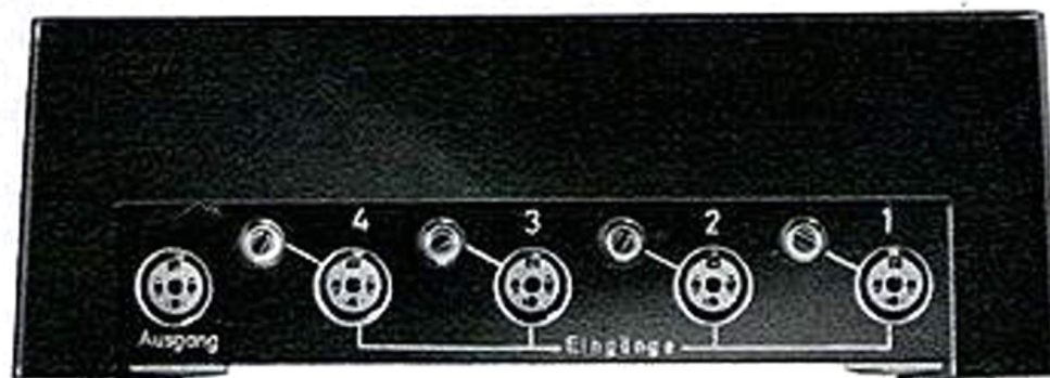
Rückansicht des Regiemixers mit Eingangsbuchsen
