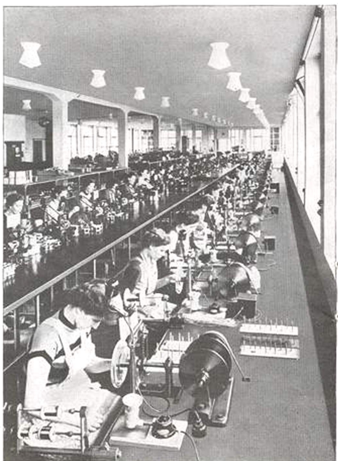
Hier werden die neuartigen SABA-Mikrofilter gewickelt
