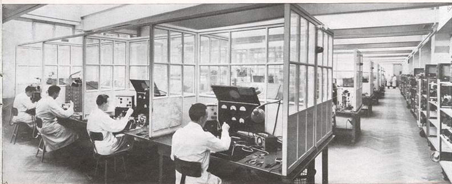
Die elektrische Schlußprüfung erfolgt in Einzelkabinen
