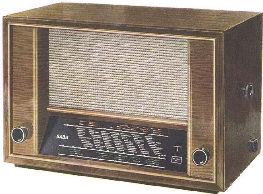
SABA 357 WKII Hochleistungs-Bandfilter-Achtkreis-Dreiwellenbereich-Super
