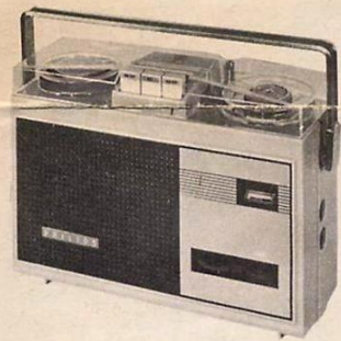
Philips-RK 5 Luxus. Ein bewährter 2spur-Batterie-Tonbandkoffer für Mono. Techn. Daten: 4,75 cm/sec. Spulen Ø max. 10 cm. Max. Spieldauer 2×90 Min. für 270-m-Dreifach-Spielband. Frequenzbereich 80-8000 Hz. 7 Trans. + 1 Ge. Diode, 4 Drucktasten für Aufnahme, Wiedergabe, schneller Vorlauf und Rücklauf, 1 Lautsprech. Stromvers. 6 Monozellen je 1,5 V oder mit Netzgerät EL 3786.
