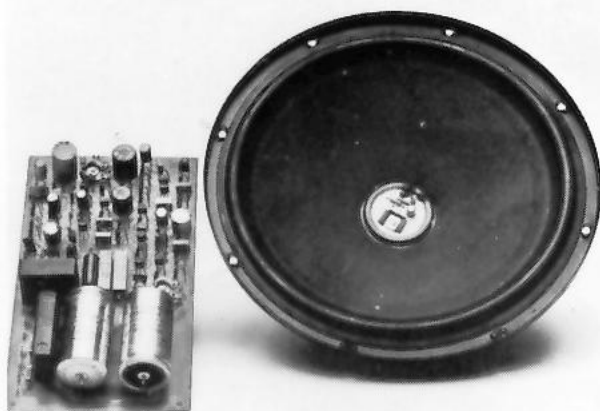
Lautsprecher mit eingebautem Sensor und dazugehörige Elektronik
