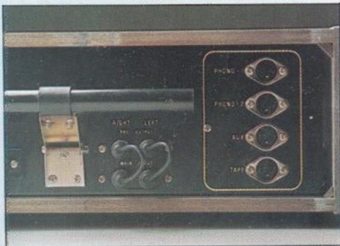
Teil-Rückansicht R 5000. Links: Ferritantenne. Mitte: Trennbarer Ausgang Vorverstärker/ Eingang Leistungsverstärker Rechts: DIN-Buchsen für Phono 1 und 2, Aux, Tape.
