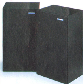
CS-595 3-WEG LAUTSPRECHERSYSTEM MIT 20cm TIEFTÖNER: Baßreflex-System - 3-Weg: 20cm-Tieftöner, 7,7cm-Konus-Mittelöner, 6,6cm-Konus-Hochtöner - Max. Musikbelastbarkeit 70W (DIN).
