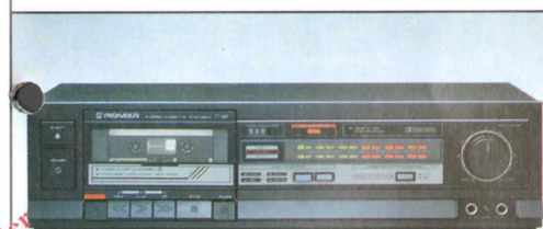
CT-660 (BK)/CT-660 KASSETTENDECK: Dolby ® B - Cue- und Review-Möglichkeit - One-Touch Aufnahme - Zeitschaltuhrfunktion - Kurzhubtasten (Auch mit DIN-Buchse lieferbar als Modell CT-660D).
