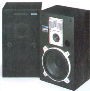
CS-999 3-WEG LAUTSPRECHERSYSTEM MIT 25cm TIEFTÖNER: Baßreflex-System - 3-Weg: 25cm-Tieftöner, 7,7cm-Konus-Mittelöner, 6,6cm-Konus-Hochtöner mit Akustik-Linse - Schutzschaltung f. Mittelöner - Max. Musikbelastbarkeit 150W (DIN).
