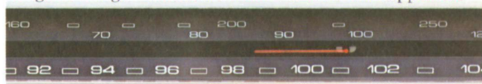
Wenn auf "manual" gestellt ist, zeigt diese Anzeige die Feldstärke des eingestellten Senders an. Auf "preset" zeigt das Instrument die Senderfrequenz an.
