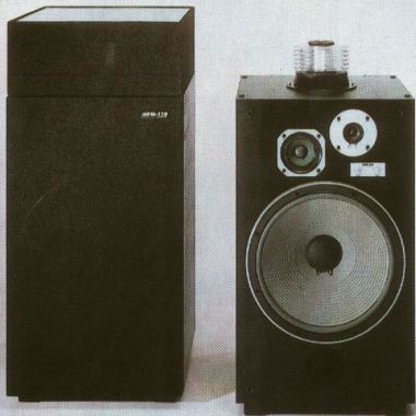
HPM-150 4-Wege-4-Lautsprecher-Baßreflexbox mit 40-cm-Tieftöner, Membran Carbon-Fiber-vernisch, 10-cm-Mitteltöner, 4,5-cm-Hochtöner und dem exklusiven rundumstrahlenden Super-Tweeter von Pioneer. Mittelton- und Hochtönpiegel von Frontplatte regelbar. Frequenzbereich 25–25 000 Hz. Belastbarkeit 125 Watt nominal, 300 Watt Maximum. Empfindlichkeit 92,5 dB/W bei 1 m.
