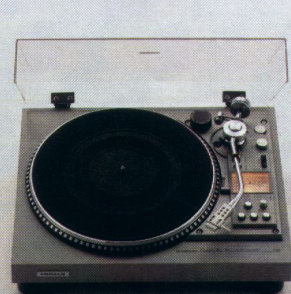
PL-560 Quarz-PLL-vollautomatischer direktgetriebener Plattenspieler Gleicher Antrieb und Anzeigeeinrichtung für Drehzahl wie PL-630, mit Motor für den Tonarm. Ölgedämpfte Absenkvorrichtung. Wiederholfunktion, Wähleinrichtung für Plattendurchmesser, Stroboskop und \pm 6\% Geschwindigkeitsfeinregulierung. Modernste Anti-Mikrofonie-Entwicklung von Pioneer mit dem S-Rohrtonarm. Tonhöhen-schwankung \pm 0,035\% nach DIN, Rumpelabstand mehr als 73 dB nach DIN B.
