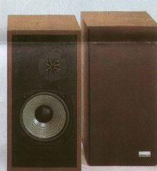
CS-E 421 60 Watt, 2-Wege-2-Lautsprecher-Box nach dem Prinzip der geschlossenen Schallwand. Tieftöner 20 cm mit Carbon-Fiber-vernischter Membran, 2,5-cm-Kalotten-Hochtöner mit Klangzerstreuer für die hohen Frequenzen. Frequenzbereich 35–20 000 Hz. Empfindlichkeit 90 dB/W.
