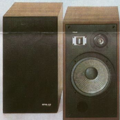
HPM-40 3-Wege-3-Lautsprecher-Baßreflexbox mit 25-cm-Tief/Mitteltöner, Carbon-Fiber-gemischter Membran, 4,5-cm-Carbon-Fiber-Hochtöner und halbzylindrischem High-Polymer-Super-Tweeter für Höhenabstrahlung von ca. 180°. Frequenzbereich 35–25 000 Hz. Empfindlichkeit 91 dB/W bei 1 m. Belastbarkeit 40 Watt.
