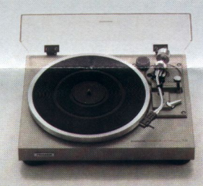
PL-514 riemengetriebener halbautomatischer Plattenspieler AC-Motor, abhängig nur von der Frequenz, nicht von der Versorgungsspannung für größere Stabilität. Gleicher Tonarm, gleiche Rückholautomatik, Abschaltautomatik und Antiskating sowie die ölgedämpfte Absenkvorrichtung wie bei den teureren halbautomatischen Plattenspielern. Tonhöhen-schwankung \pm 0,06\% nach DIN, Rumpelabstand 65 dB nach DIN B.
