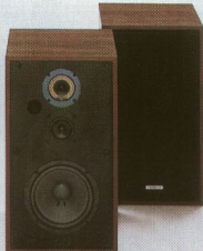
CS-424 60 Watt, kompakte 3-Wege-3-Lautsprecher-Baßreflexbox mit 20-cm-Tieftöner, Membran Carbon-Fiber-vernisch, 6,6-cm-Konus-Mitteltöner und 4,5-cm-Konus-Hochtöner. Frequenzbereich 40–20 000 Hz. Empfindlichkeit 92 dB/W bei 1 m.
