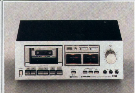
CT-F 500 Dolby-Cassettenmaschine mit automatischer Stop-Einrichtung Antrieb mit DC-Servomotor, separatem Riemenantrieb zum unabhängigen Antrieb der Tonwelle und der Bandwelle. Die senkrecht stehende Schutzkappe hat eine besonders sanft arbeitende pneumatische Dämpfung und kann leicht zur Tonkopfkontrolle entfernt werden. Aufnahme/Wiedergabekopf aus Hart-Permalloy und Löschkopf aus Ferrit. Tonhöhen-schwankung \pm 0,17\% nach DIN, Frequenzgang bei Chromband 40–15.000 Hz \pm 3 dB.
