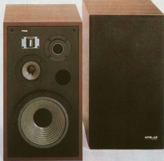
HPM-60 4-Wege-4-Lautsprecher-Baßreflexbox mit 25-cm-Tieftöner, Membran Carbon-Fiber-vernisch, hochqualitativem 10-cm-Mitteltöner, 4,5-cm-Konus-Hochtöner und halbzylindrischem High-Polymer-Super-Tweeter. Frequenzbereich 35–25 000 Hz. Empfindlichkeit 92,5 dB/W bei 1 m. Belastbarkeit 60 Watt.
