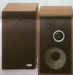
CS-E 531 80 Watt, 3-Wege-3-Lautsprecher-Box, Prinzip der geschlossenen Schallwand, mit 25-cm-Tieftöner. Membran mit Carbon-Fiber, 6,5-cm-Mitteltöner mit Kalotte und 2,5-cm-Kalotten-Hochtöner. Polyurethan-Aufhängung und lange Schwingspule. Frequenzbereich 35–20 000 Hz. Empfindlichkeit 90 dB/W.
