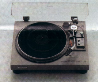
PL-518 direktgetriebener halbautomatischer Plattenspieler Das gleiche sorgfältig entwickelte Anti-Mikrofonie-Gehäuse wie PL-540, zusätzlich ebenfalls neu entwickelt ein superhartes Chromstahl-Lager zur Verbesserung der Abtasteigenschaften des S-förmigen Tonarms. Der leichtgewichtige Plattenteller wird direkt getrieben durch einen 16poligen DC-Servomotor. Tonhöhen-schwankung \pm 0,04\% nach DIN. Geschwindigkeitsfeinregulierung \pm 2\% .
