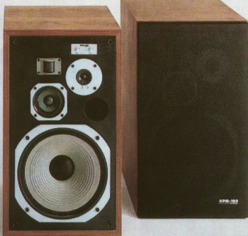
HPM-100 4-Wege-4-Lautsprecher-Baßreflexbox mit 30-cm-Tieftöner, Membran Carbon-Fiber-vernisch, 10-cm-Mitteltöner mit hochkantgewinkelter Schwingspule, 4,5-cm-Hochtöner und halbzylindrischem High-Polymer-Super-Tweeter für breiteste Abstrahlung der Höhen. Frequenzbereich 30–25 000 Hz. Empfindlichkeit 92,5 dB/W bei 1 m. Belastbarkeit 100 Watt.
