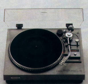
PL-540 Quarz-PLL-direktgetriebener halbautomatischer Plattenspieler Neu entwickelte Rückhol-Automatik, getestet in mehr als 100.000 ununterbrochenen Zyklen. Bürstenloser DC-Hall-Motor, aufgebaut auf einem gegossenen Aluminium von 4 mm Dicke, vom Plattenteller und Tonarm isoliert. Enthält ein vereinfachtes Stroboskop, bei dem die Stroboskop-Beleuchtung vom Quarz-Oszillator gesteuert wird. Tonhöhen-schwankung \pm 0,035\% nach DIN, Rumpelabstand mehr als 73 dB nach DIN B.
