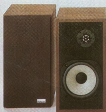
CS-E 321 40 Watt, 2-Wege-2-Lautsprecher-Box nach dem Prinzip der geschlossenen Schallwand, mit 20-cm-Tieftöner. Membran Carbon-Fiber-vernisch, 2,5-cm-Kalotten-Hochtöner mit speziellem Klangzerstreuer für bessere Höhenabstrahlung. Frequenzbereich 45–20 000 Hz. Empfindlichkeit 88 dB/W bei 1 m.
