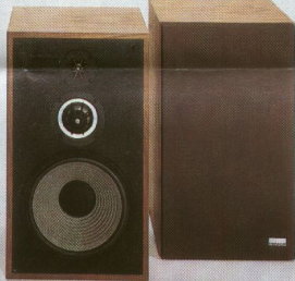
CS-E 731 100 Watt, 3-Wege-3-Lautsprecher-Box nach dem Prinzip der geschlossenen Schallwand. Tieftöner 30 cm mit Carbon-Fiber-vernischter Membran, 6,5-cm-Mitteltöner mit Kalottenmembran und 2,5-cm-Hochtöner mit spezieller Titanmembran, aufgehängt in Polyurethan-Schaum. Frequenzbereich 35–20 000 Hz. Empfindlichkeit 89 dB/W bei 1 m.
