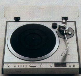
PL-630 Quarz-PLL-vollautomatischer direktgetriebener Plattenspieler Voll elektronisches Luxusmodell mit Sensoren, Leuchtdiodenanzeigen und Anzeigeelement. Bürstenloser DC-Hall-Motor für den Plattentellerantrieb und DC-Motor für die Tonarmbewegung. Geschwindigkeitsfeinregulierung \pm 6\% , Spielunterbrechung, opto-elektronische Steuerung der Tonarmbewegung bei Platteneindeckung, statisch balancierter S-Rohrtonarm. Tonhöhen-schwankung \pm 0,035\% nach DIN, Rumpelabstand 75 dB nach DIN B.
