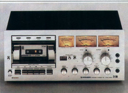
CT-F 700 Dolby-Stereo-Cassettenbandmaschine mit Dynamik-Anzeige Das dritte Instrument ist auf 3 Betriebsarten schaltbar: Dynamik-Anzeige, Bias-einstellung und Höhenaussteuerung. Automatische Chromumschaltung, Memory-Stop, Schalluhrbetrieb möglich. Tonhöhen-schwankung \pm 0,17\% nach DIN, Frequenzgang bei Chromband 30–16.000 Hz \pm 3 dB.
