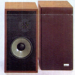
CS-E 421 60 Watt, 2-Wege-2-Lautsprecher-Box nach dem Prinzip der geschlossenen Schallwand. Tieftöner 20 cm mit Carbon-Fiber-vermischter Membran, 2,5-cm-Kalotten-Hochtöner mit Klangzerstreuer für die hohen Frequenzen. Frequenzbereich 35–20 000 Hz. Empfindlichkeit 90 dB/W.
