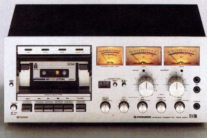
CT-F 700 Dolby-Stereo-Cassettenbandmaschine mit Dynamik-Anzeiger Das dritte Instrument ist auf 3 Betriebsarten schaltbar: Dynamikanzeige, Biaseinstellung und Höhenaussteuerung. Automatische Chromumschaltung, Memory-Stop, Schalluhrbetrieb möglich. Tonhöhen-schwankung \pm 0,17\% nach DIN, Frequenzgang bei Chromband 30-16.000 Hz \pm 3 dB.
