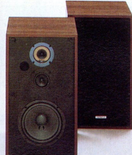
CS-424 60 Watt, kompakte 3-Wege-3-Lautsprecher-Baßreflexbox mit 20-cm-Tieftöner, Membran Carbon-Fiber-vermischt, 6,6-cm-Konus-Mitteltöner und 4,5-cm-Konus-Hochtöner. Frequenzbereich 40–20 000 Hz. Empfindlichkeit 92 dB/W bei 1 m.
