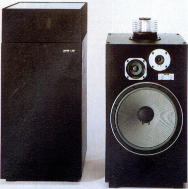
HPM-150 4-Wege-4-Lautsprecher-Baßreflexbox mit 40-cm-Tieftöner, Membran Carbon-Fiber-vermischt, 10-cm-Mitteltöner, 4,5-cm-Hochtöner und dem exklusiven rundumstrahlenden Super-Tweeter von Pioneer. Mittelton- und Hochtönpiegel von Frontplatte regelbar. Frequenzbereich 25–25 000 Hz. Belastbarkeit 125 Watt nominal, 300 Watt Maximum. Empfindlichkeit 92,5 dB/W bei 1 m.
