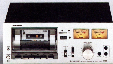
CT-F 4040 Dolby-Cassettenmaschine mit vollautomatischem Stop Mit den von Pioneer entwickelten Cassettenhalterungen, die ohne die sonst üblichen Auswurfmechanismen auskommen. Beleuchtetes Cassettenfach mit spezieller Markierung zur Anzeige des Bandvorrates. Elektronische Stummschaltung zur Unterdrückung aller Schaltgeräusche und Aufnahme/Wiedergabekopf aus Hart-Permalloy, Löschkopf aus Ferrit. Tonhöhen-schwankung \pm 0,18\% nach DIN, Frequenzgang bei Chromband 40-15.000 Hz \pm 3 dB.
