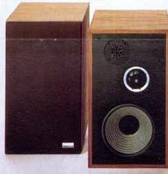
CS-E 531 80 Watt, 3-Wege-3-Lautsprecher-Box, Prinzip der geschlossenen Schallwand, mit 25-cm-Tieftöner. Membran mit Carbon-Fiber, 6,5-cm-Mitteltöner mit Kalotte und 2,5-cm-Kalotten-Hochtöner. Polyurethan-Aufhängung und lange Schwingspule. Frequenzbereich 35–20 000 Hz. Empfindlichkeit 90 dB/W.
