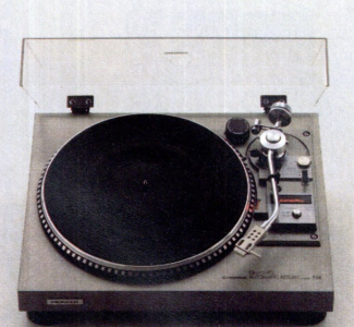
PL-540 Quarz-PLL-direktgetriebener halbautomatischer Plattenspieler Neu entwickelte Rückhol-Automatik, getestet in mehr als 100.000 ununterbrochenen Zyklen. Bürstenloser DC-Hall-Motor, aufgebaut auf einem gegossenen Aluminium von 4 mm Dicke, vom Plattenteller und Tonarm isoliert. Enthält ein vereinfachtes Stroboskop, bei dem die Stroboskop-Beleuchtung vom Quarz-Oszillator gesteuert wird. Tonhöhen-schwankung \pm 0,035\% nach DIN, Rumpelabstand mehr als 73 dB nach DIN B.
