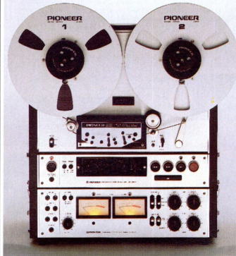
RT-2022 riemengetriebene Spulentonbandmaschine mit Studio-Geschwindigkeit 3-Motoren-3-Kopf-System, gebaut nach professionellen Spezifikationen mit Bandgeschwindigkeiten 19 und 38 cm/s. Separate Einheiten für Bandtransport, Verstärker und Kopfrägerplatte. Fortgeschrittene Tonbandfreunde können durch einfaches Austauschen der Kopfrägerplatte von 2-Spur-2-Kanal auf 4-Spur-4-Kanal und durch Zusatz eines weiteren Verstärkers TAU-11 bestmögliche Flexibilität und Einsatzmöglichkeiten erreichen. Enthält sowohl NAB- als auch IEC-Entzerrung, stufenlos einstellbare Vormagnetisierung, eingebauter Testoszillator. Tonhöhenstreuung ±0,06% nach DIN, Spulengröße 26,5 cm.
