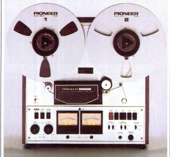
RT-1011 L 4-Spur-riemengetriebene Spulentonbandmaschine Drei Motoren, drei Köpfe, zwei Geschwindigkeiten 9,5 und 19 cm/s. Magnetgesteuert mit vollglosschem Bandantrieb, eingerichtet für Schaltbetrieb und Wiedergabe. Hyperbolische Tonköpfe aus Permalloy. Hysteresis-Synchron-Motor zum Tonwellenantrieb und spezielle Induktionsmotoren für die Spulenantriebe. Eingerichtet für 26,5 cm, professionelle Spulen für besonders lange Spielzeiten. Vierfach-Umschaltung für Vormagnetisierung und Entzerrung und viele weitere Einzelheiten. Frequenzgang 30–24 000 Hz nach DIN bei 19 cm/s. Tonhöhenstreuung ±0,15% nach DIN bei 19 cm/s.
