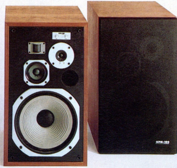
HPM-100 4-Wege-4-Lautsprecher-Baßreflexbox mit 30-cm-Tieftöner, Membran Carbon-Fiber-vermischt, 10-cm-Mitteltöner mit hochkantgewickelter Schwingspule, 4,5-cm-Hochtöner und halbzylindrischem High-Polymer-Super-Tweeter für breiteste Abstrahlung der Höhen. Frequenzbereich 30–25 000 Hz. Empfindlichkeit 92,5 dB/W bei 1 m. Belastbarkeit 100 Watt.
