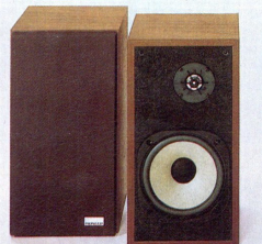
CS-E 321 40 Watt, 2-Wege-2-Lautsprecher-Box nach dem Prinzip der geschlossenen Schallwand, mit 20-cm-Tieftöner. Membran Carbon-Fiber-vermischt, 2,5-cm-Kalotten-Hochtöner mit speziellem Klangzerstreuer für bessere Höhenabstrahlung. Frequenzbereich 45–20 000 Hz. Empfindlichkeit 88 dB/W bei 1 m.
