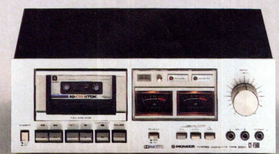
CT-F 500 Dolby-Cassettenmaschine mit automatischer Stop-Einrichtung Antrieb mit DC-Servomotor, separatem Riemenantrieb zum unabhängigen Antrieb der Tonwelle und der Bandwickel. Die senkrecht stehende Schutzkappe hat eine besonders sanft arbeitende pneumatische Dämpfung und kann leicht zur Tonkopfkontrolle entfernt werden. Aufnahme/Wiedergabekopf aus Hart-Permalloy und Löschkopf aus Ferrit. Tonhöhen-schwankung \pm 0,17\% nach DIN, Frequenzgang bei Chromband 40-15.000 Hz \pm 3 dB.
