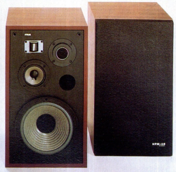
HPM-60 4-Wege-4-Lautsprecher-Baßreflexbox mit 25-cm-Tieftöner, Membran Carbon-Fiber-vermischt, hochqualitativem 10-cm-Mitteltöner, 4,5-cm-Konus-Hochtöner und halbzylindrischem High-Polymer-Super-Tweeter. Frequenzbereich 35–25 000 Hz. Empfindlichkeit 92,5 dB/W bei 1 m. Belastbarkeit 60 Watt.
