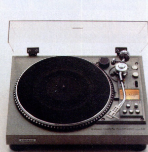
PL-560 Quarz-PLL-vollautomatischer direktgetriebener Plattenspieler Gleicher Antrieb und Anzeigeeinrichtung für Drehzahl wie PL-630, mit Motor für den Tonarm. Ölgedämpfte Absenkvorrichtung, Wiederholfunktion, Wähl-einrichtung für Plattendurchmesser, Stroboskop und \pm 6\% Geschwindigkeitsfeinregulierung. Modernste Anti-Mikrofonie-Entwicklung von Pioneer mit dem S-Rohrtonarm. Tonhöhen-schwankung \pm 0,035\% nach DIN, Rumpelabstand mehr als 73 dB nach DIN B.
