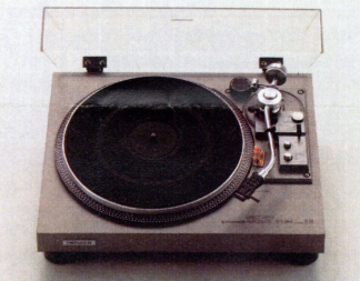
PL-518 direktgetriebener halbautomatischer Plattenspieler Das gleiche sorgfältig entwickelte Anti-Mikrofonie-Gehäuse wie PL-540, zusätzlich ebenfalls neu entwickelt ein superhartes Chromstahl-Lager zur Verbesserung der Abtast-eigenschaften des S-förmigen Tonarms. Der leichtgewichtige Plattenteller wird direkt getrieben durch einen 16poligen DC-Servomotor. Tonhöhen-schwankung \pm 0,04\% nach DIN, Geschwindigkeitsfeinregulierung \pm 2\% .
