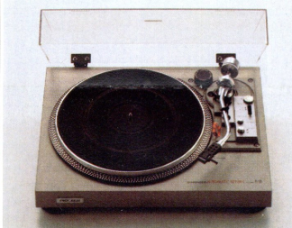
PL-516 FG-Servo-riemengetriebener halbautomatischer Plattenspieler Synchronmotor mit hohem Drehmoment, unabhängig von Fluktuationen der Netzspannung. Leicht zu kontrollierendes Stroboskop, Drehzahlfeinregulierung von \pm 2\% . Statisch balancierter, S-förmiger Tonarm, gelagert im Kugellager mit 34 feinen Kugeln sowie einem neuartigen Chromstahl-Lager für die vertikale Bewegung. Tonhöhen-schwankung \pm 0,05\% nach DIN.
