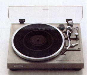
PL-514 riemengetriebener halbautomatischer Plattenspieler AC-Motor, abhängig nur von der Frequenz, nicht von der Versorgungsspannung für größere Stabilität. Gleicher Tonarm, gleiche Rückholautomatik, Abschaltautomatik und Antiskating sowie die ölgedämpfte Absenkvorrichtung wie bei den teureren halbautomatischen Plattenspielern. Tonhöhen-schwankung \pm 0,06\% nach DIN, Rumpelabstand 65 dB nach DIN B.
