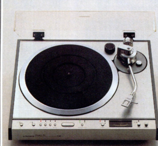
PL-630 Quarz-PLL-vollautomatischer direktgetriebener Plattenspieler Voll-elektronisches Luxusmodell mit Sensoren, Leuchtdiodenanzeigen und Anzeigeelement. Bürstenloser DC-Hall-Motor für den Plattentellerantrieb und DC-Motor für die Tonarmbewegung. Geschwindigkeitsfeinregulierung \pm 6\% , Spielunterbrechung, opto-elektronische Steuerung der Tonarmbewegung bei Platteneinde, statisch balancierter S-Rohrtonarm. Tonhöhen-schwankung \pm 0,035\% nach DIN, Rumpelabstand 75 dB nach DIN B.
