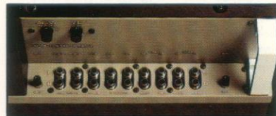
Eingänge und Ausgänge an der Seite des Chassis für leichte Zugänglichkeit.
