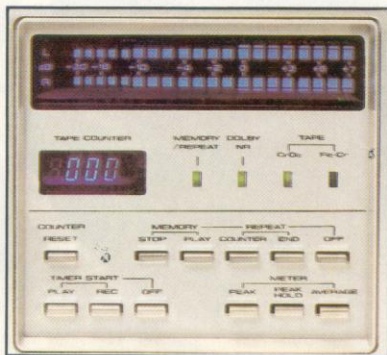
Pegelanzeige mit Mikroprozessor und Digital-Bandzähler des CT-F 900
