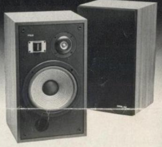
HPM-40 Drei Wege, drei Lautsprecher, Baßreflexsystem. 25-cm-Carbon-Fiber-Tieftöner. 4,5-cm-Hochtöner. High-Polymer-Super-Tweeter mit 180° Abstrahlwinkel und satinierte Fläche. Übertragungsbereich 35 Hz bis 25 000 Hz. Belastbarkeit 40 Watt.
