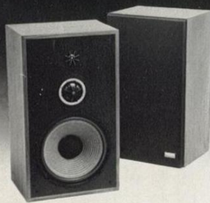
CS-E 731 Drei Wege, 3-Lautsprecher-System mit 30-cm-Carbon-Fiber-Tieftöner. 6,5-cm-Kalotten-Mitteltöner. 2,5-cm-Kalotten-Hochtöner. Übertragungsbereich 35 Hz bis 20 000 Hz. Maximale Belastbarkeit 100 Watt.
