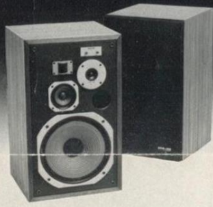
HPM-100 Vier Wege, vier Lautsprecher, Baßreflexsystem. 30-cm-Carbon-Fiber-Tieftöner. 10-cm-Mitteltöner. 4,5-cm-Hochtöner. High-Polymer-Super-Tweeter mit 180° Abstrahlwinkel und satinierte Fläche. Übertragungsbereich 30 Hz bis 25 000 Hz. Belastbarkeit 100 Watt.
