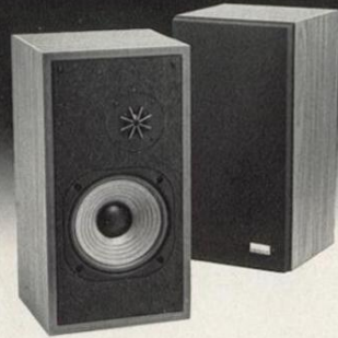
CS-E 421 2-Wege-Regalbox mit 20-cm-Carbon-Fiber-Tieftöner. 2,5-cm-Kalotten-Hochtöner. Übertragungsbereich 35 Hz bis 20 000 Hz. Maximale Belastbarkeit 60 Watt.
