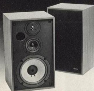
CS-515 Drei Wege, 3-Lautsprecher-Baßreflexsystem. 25-cm-Carbon-Fiber-Tieftöner. 12-cm-Mitteltöner. 2,5-cm-Kalotten-Hochtöner. Übertragungsbereich 35 Hz bis 20 000 Hz. Maximale Belastbarkeit 50 Watt.
