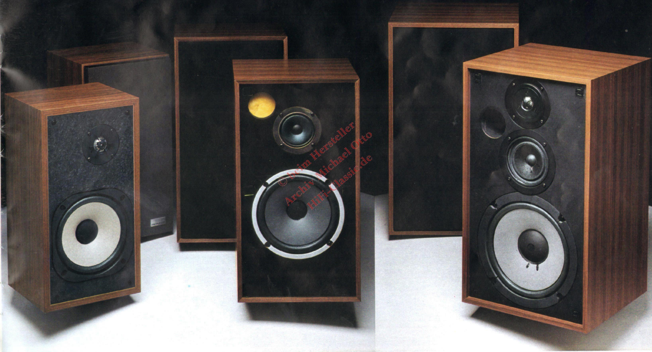
CS-515 Drei Wege, 3-Lautsprecher-Baßreflexsystem. 25-cm-Carbon-Fiber-Tieftöner, 12-cm-Mitteltöner, 2,5-cm-Kalotten-Hochtöner. Übertragungsbereich 35 Hz bis 20 000 Hz. Maximale Belastbarkeit 50 Watt.
