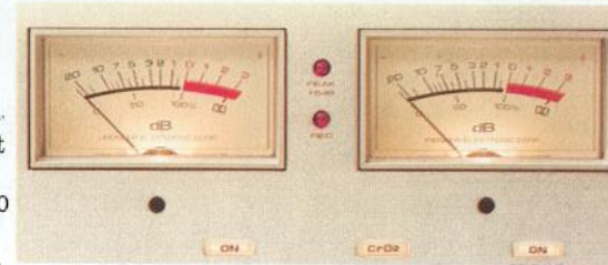
Übersichtliche Aussteuerungsinstrumente und Spitzenleuchtanzeige (CT-F 8080).
