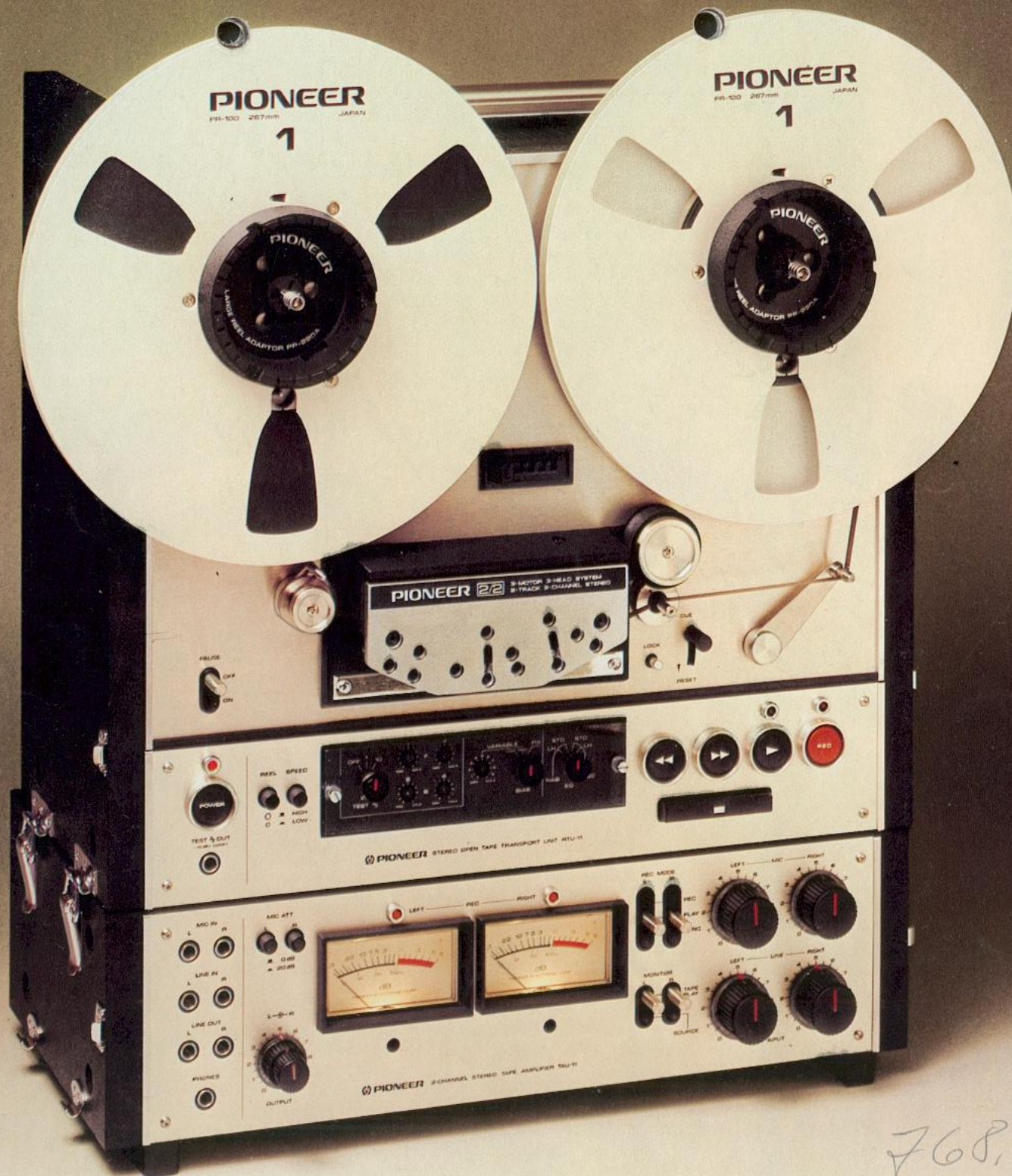
RT-202: Professionelles Spulentonbandgerät. Zwei Spuren. Zwei Kanäle. Drei Motoren. Capstan-Antrieb. 38 cm/sec und 19 cm/sec. Gleichlaufschwankungen weniger als 0,04 % (JIS). Geräuschspannungsabstand mehr als 57 dB. Übertragungsbereich 30 Hz–28 kHz ( \pm 3 dB bei 38 cm/sec). Auswechselbare Tonkopfeinheit. Separate Aufnahme-/Wiedergabe-Verstärker-Einheit.
