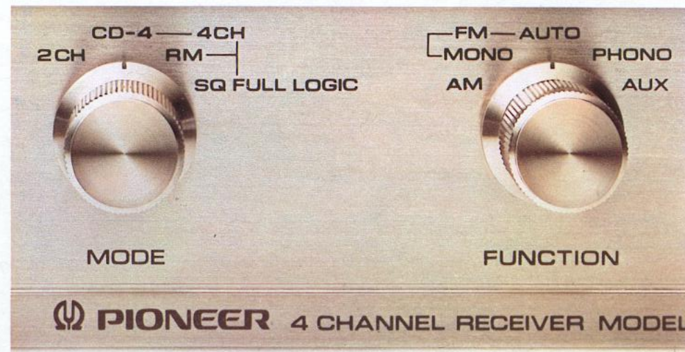
Betriebsarten und Eingangswahlschalter des QX-747 A.
