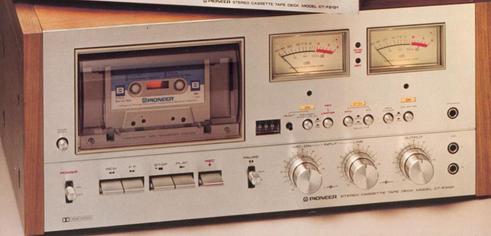
146,-$ CT-F 2121 (oben): Stereo-Cassettendeck mit Frontbedienung. Dolby. Unabhängige Schalter für Vormagnetisierung und Entzerrung. Permalloy-Tonköpfe. Automatik-Stop. Gleichlaufschwankungen weniger als 0,20% (DIN). Übertragungsbereich 30 Hz – 16 kHz (Chrom). Geräuschspannungsabstand 58 dB (Dolby).
