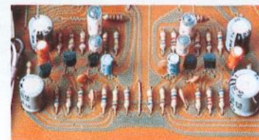
Zweistufiger direktgekoppelter Phono-Entzerrer des SA-7500.
