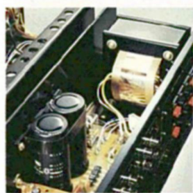
●大型電源・トランス、大容量コンデンサー
