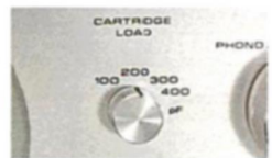
負荷容量切換えによる特性の変化
