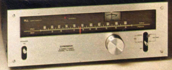
TX-5300: Hochempfindlicher und trennscharfer UKW-Stereo-/MW-Tuner mit integrierten Schaltungen. PLL-Multiplex-Decoder. Geräuschspannungsabstand 70 dB. Empfindlichkeit 1,6 µV (DIN). 10,8 dBf (IHF).
