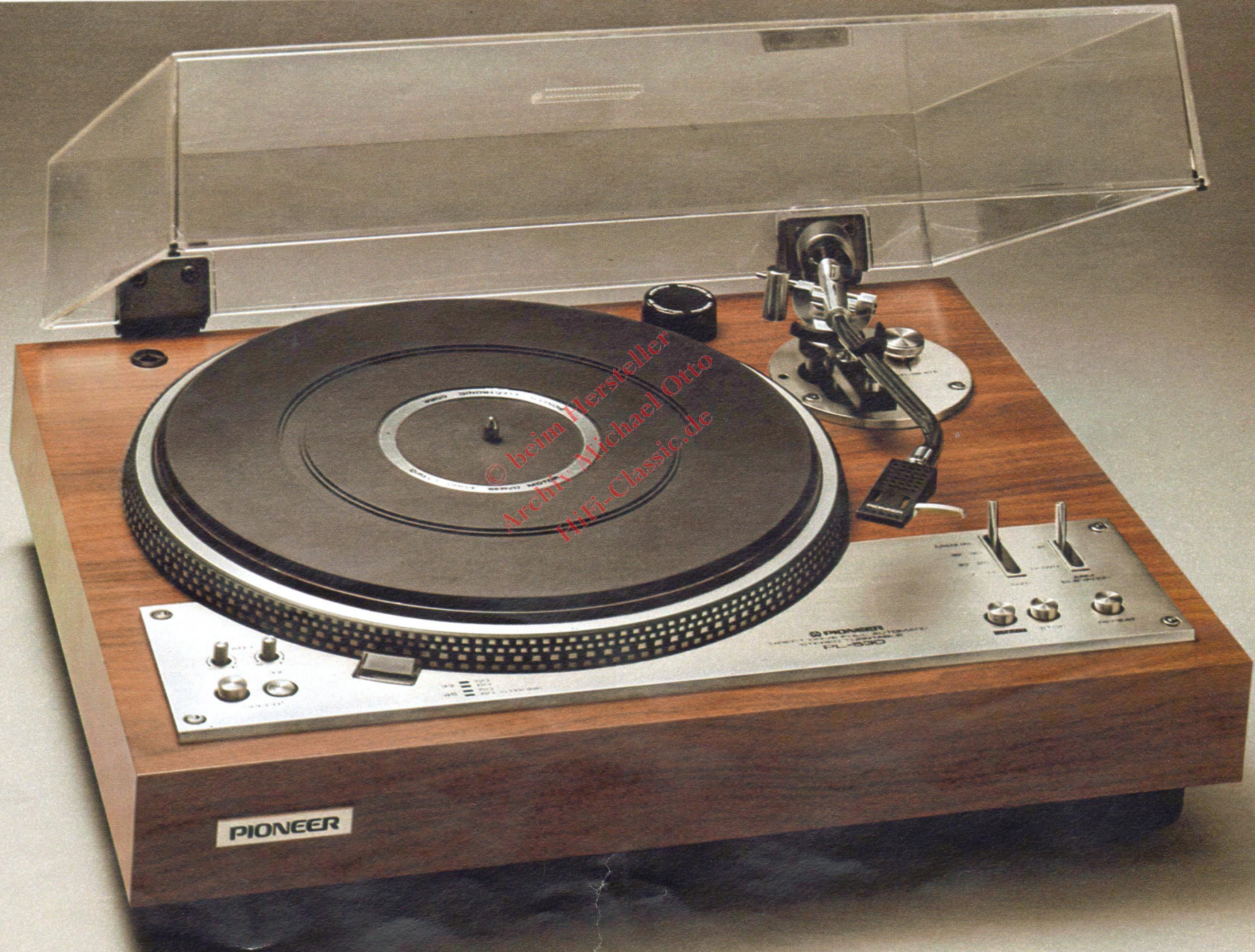
PL-530: Vollautomatischer, direktgetriebener zweimotoriger Plattenspieler. Servogesteuerter DC-Hallmotor. Alle Automatikfunktionen mit separatem Motor. Doppeltes Aufhängungssystem. S-förmiger Rohrtonarm.
