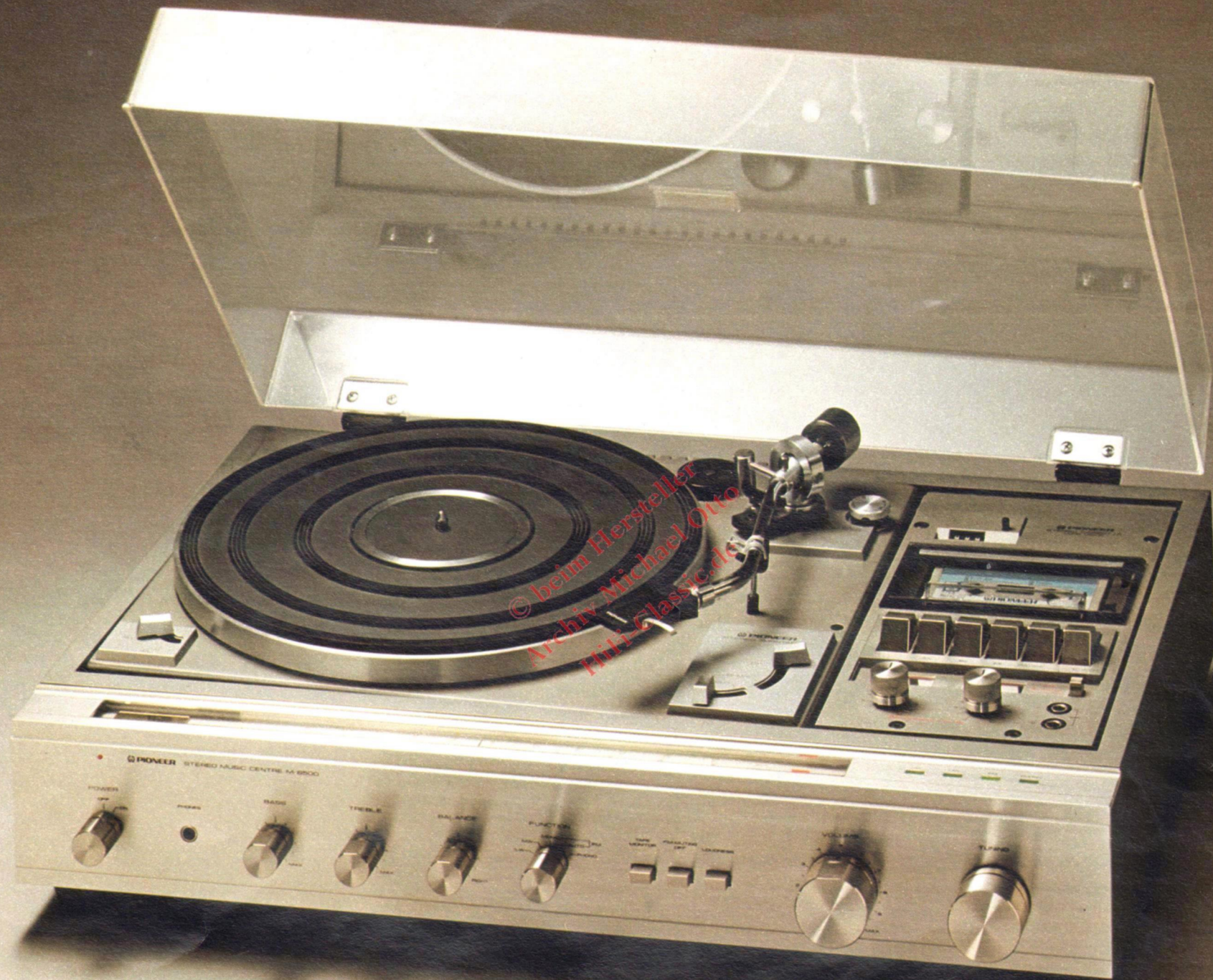
M-6500, Stereo-Musik-Center mit Plattenspieler, Tuner, integriertem Vollverstärker und Stereo-Cassettendeck. Tuner, Plattenspieler und Verstärker in gleicher Ausführung wie M-6000. Das Cassettendeck ist mit diversen Features ausgestattet: Pausentaste, Bandwählschalter (Normal/Chrom), Bandzählwerk und Auto-Stop-Mechanismus. Gleichlaufschwankungen kleiner als 0,13% (JIS). Frequenzgang: 30 Hz – 15 kHz (Chrom).
