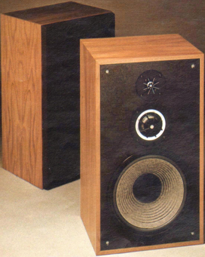
CS-E 731: 100 Watt, drei Wege, drei Lautsprecher. Mit 30-cm-Kohlefiber-Tiefton-Membrane, 6,5-cm-Kalottenmitteltöner und 2,5-cm-Kalottenhochtöner.
