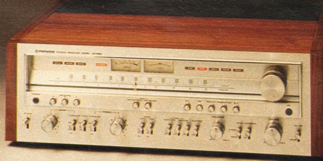
SX-950: UKW/MW-Stereo-Receiver. 2×135 Watt Sinus-Ausgangsleistung an 4 Ohm (DIN). UKW-Empfindlichkeit: 1,6 µV (DIN), 10,3 dBf (IHF). FM-Muting. Zweistufige Klangregelung. Tiefen- und Höhenfilter. Tape-Duplicate. Fünf Stereo-Eingänge. Anschluß für drei Lautsprecherpaare. Trennbarer Vor- und Endverstärker. Empfang dolbysierter UKW-Sendungen.
