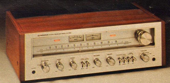
SX-650: UKW/MW-Stereo-Receiver. 2×45 Watt Sinus-Ausgangsleistung an 4 Ohm (DIN). UKW-Empfindlichkeit: 1,7 µV (DIN), 10,7 dBf (IHF). FM-Muting. Anschluß für zwei Tonbandgeräte mit Überspielen und zwei Lautsprecherpaare.
