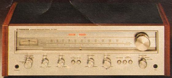
SX-550: UKW/MW-Stereo-Receiver. 2 x 30 Watt Sinus-Ausgangsleistung an 4 Ohm (DIN). UKW-Empfindlichkeit: 1,8 µV (DIN), 11,2 dBf (IHF). FM-Muting. Anschluß für zwei Tonbandgeräte mit Überspielen und zwei Lautsprecherpaare.
