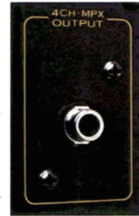
MPX out terminal.
