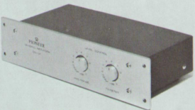
DN-31 (3-weg) Impedanz 8 Ohm Abschwächung 12 dB / oct. Übergangsfrequenzen Bass-, Mittelton 750 Hz Mittel-, Hochtton 4 500 Hz Maximal-Leistung 80 Watt
