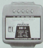
DN-6 Impedanz 8 Ohm Abschwächung 12 dB / oct. Übergangsfrequenz bei 2-weg 4 000 Hz bei 3-weg 500 und 4 000 Hz Maximal-Leistung 30 Watt
