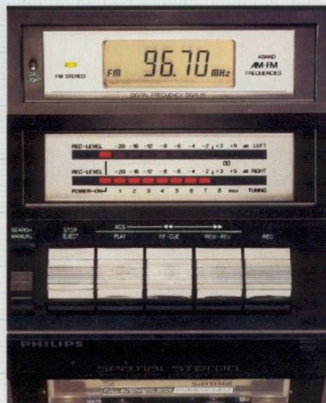
Die Kontrolleinheit. Hier sehen Sie exakt, auf welchem Wellen- bereich und auf welcher Frequenz Sie gerade empfangen, ob in Stereo oder Mono. Die Anzeige-Displays zeigen die Stärke des Empfangssignals oder wie hoch die Cassette ausgesteuert ist.
