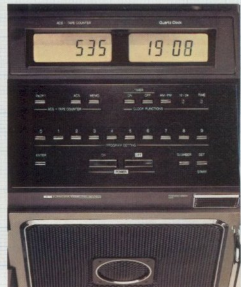
Die Vorwähleinheit. Mit dem automatischen Computer-Such- lauf können Sie direkt Musikstücke auf der Cassette anwählen. Die integrierte Quarz- uhr kann zu programmierten Zeiten das Gerät ein- oder ausschalten. Rundfunk oder Cassette.
